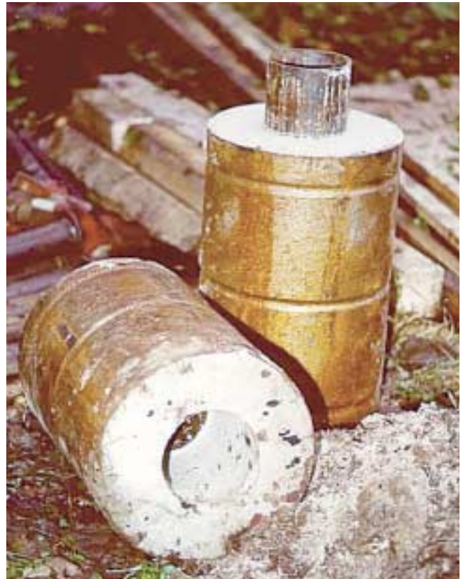
4 Pfahlsegmente mit Nut und Feder
